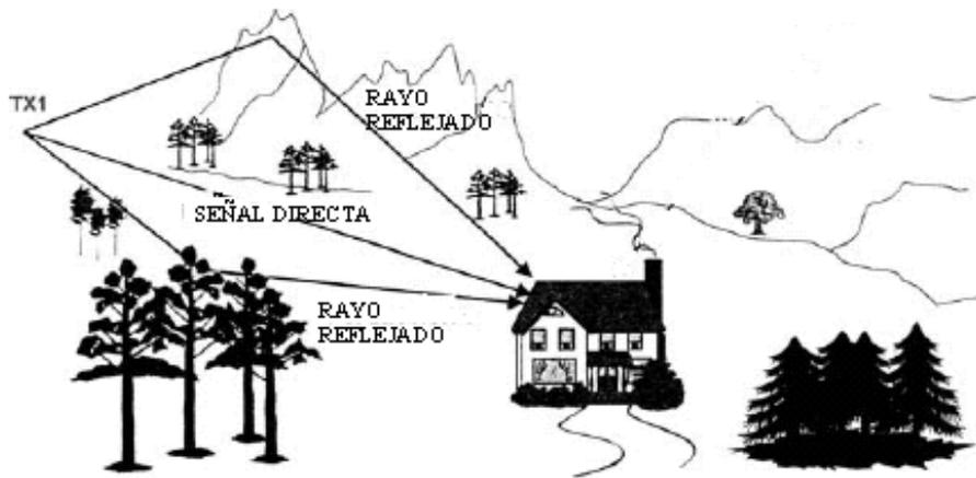
a) Diagrama del efecto del multitrayecto.
