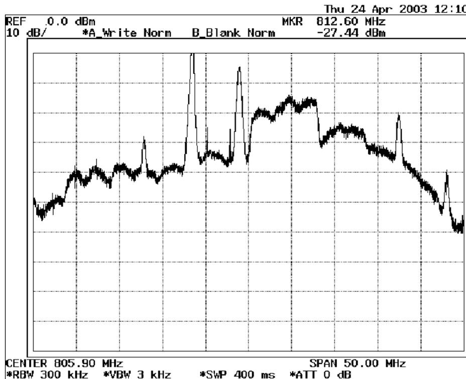
Figura 53. Salida del amplificador bicanal con IM =25 dB.
