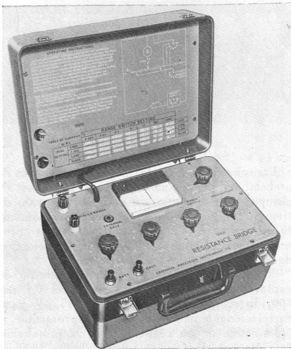
El aparato es autónomo y funciona por medio de siete pilas de 1,5 voltios, que se encuentran en la tapa. El circuito utiliza un reductor de voltaje Kelvin-Varley, que incorpora cuatro esferas medidoras con calibraciones de  $9 \times 1.000$ ,
