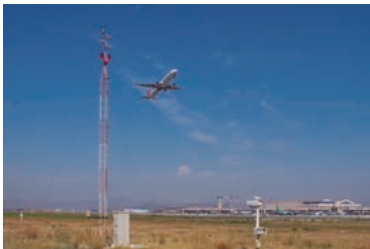
Instrumentación meteorológica para la observación del viento y el alcance visual en pista en el aeropuerto de Málaga. (Foto: AEMET)
