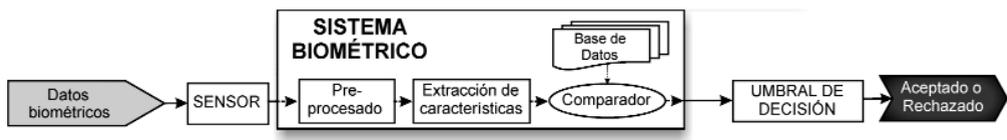
**Figura 1.** Arquitectura de un sistema de reconocimiento biométrico.
