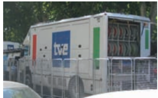
Trasera de la unidad Digital I enseñando los carretes de cables motorizados. Foto: Carlos Alberto Martín.
