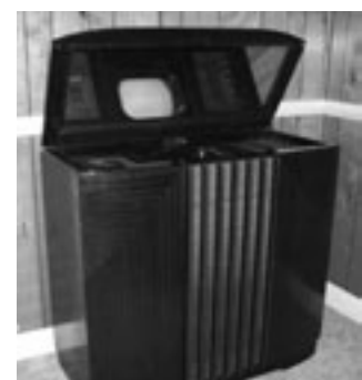
Fig. 12.- Receptor de televisión fabricado por la General Electric en 1941. Fue el primer receptor que cumplía la norma NTSC de 525 líneas en blanco y negro.
