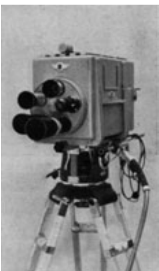
Figura 24. Cámara de televisión Philips con orticón de imagen adquirida por la Dirección General de Radiodifusión en 1955. (Revista de Telecomunicación. Diciembre 1955. pp. 87)
