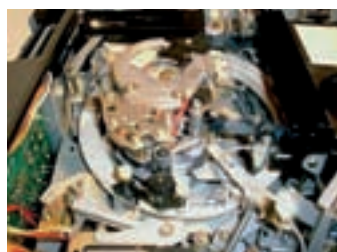
Fotografía de detalle del tambor giratorio con las cabezas grabadoras/reproductoras de vídeo.
