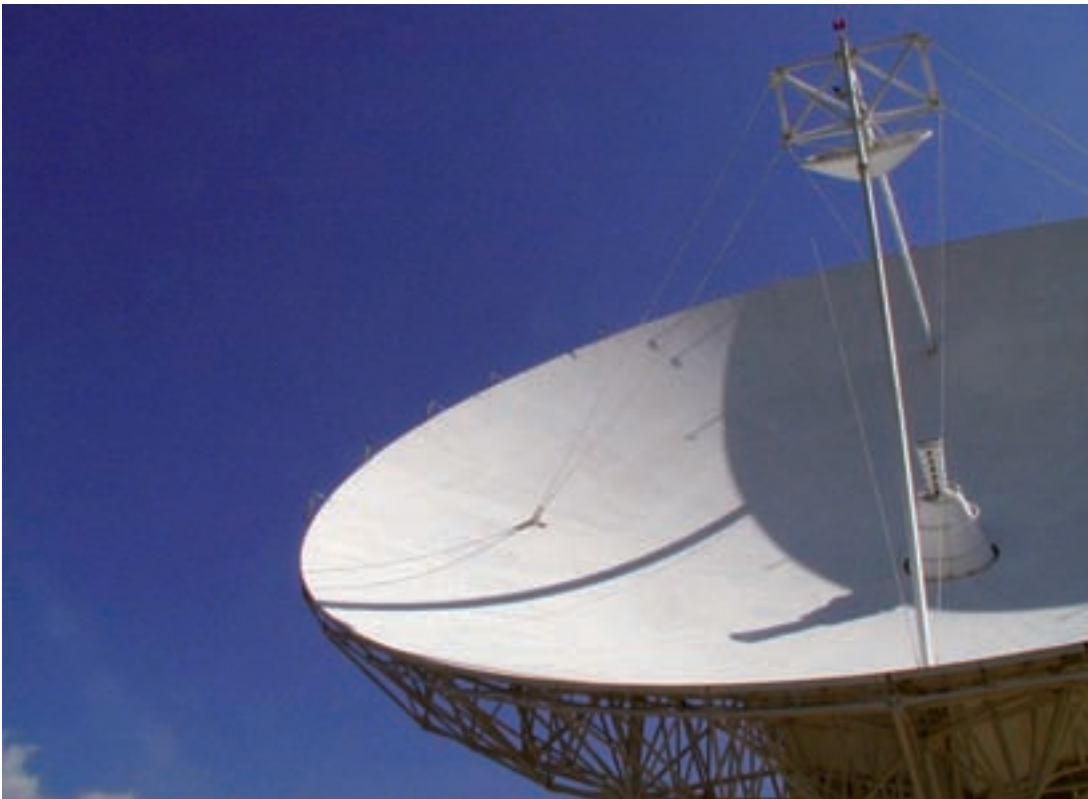
Ejemplo de estación terrena de comunicaciones para satélites de baja potencia.
