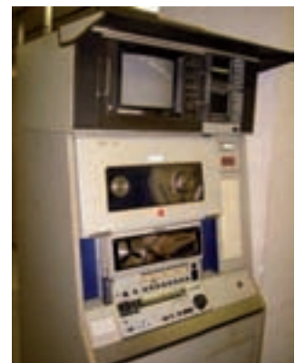
Magnetoscopio 1" C de los años 80. Este tipo de magnetoscopio helicoidal de bobina abierta se utilizaba en aquellos años en todas las producciones de calidad y delicadas.
