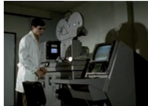
Kinescopios utilizados por Televisión Española. Estos equipos se utilizaban para trasladar a cinta cinematográfica lo que emitía televisión antes de la aparición de los magnetoscopios. Fuente:TVE.
