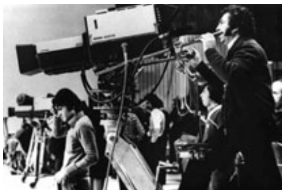
Una cámara de televisión utilizada para la captación de acontecimientos de la década de 1960. En la fotografía pueden ver las grandes dimensiones de la cámara, que incorporaba un tubo de imagen de un tamaño considerable, que nada tiene que ver con las pequeñas cámaras actuales. Fuente: TVE.
