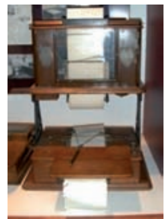
Fotografía de un telautograph primitivo. En la parte superior se encuentra el sistema receptor; y en la parte inferior el transmisor.
