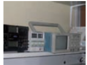
Instrumental de servicio para la reparación. Desde la aparición del color, el osciloscopio y el generador de vídeo se hicieron imprescindibles. La industria de los instrumentos ofreció en su momento versiones portátiles para el servicio a domicilio.
