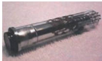
Fotografía del tubo de imagen plumbicón diseñado por Philips en 1962.
