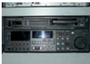
Magnetoscopio editor en formato DVCPRO 50. Usa cintas de 1/4" de ancho en las que mediante una compresión 3:1, muestreando en 4:2:2 se alcanza una velocidad de 50 Mbps DVCPRO 50. El sistema está pensado no sólo para ENG, sino también para estudios y permite grabar 4 canales de audio PCM.
