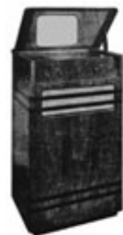
Fig. 17.- Receptor de televisión de VHF modelo T5 fabricado en 1936 por Baird. Este receptor era capaz de recibir las emisiones de los dos sistemas utilizados inicialmente por la BBC desde el Alexandra Palace: 240 y 405 líneas. (Fotografía obtenida a partir de un folleto publicitario).
