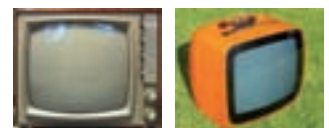
Televisor de 1968 con sintonizador de canales de VHF y sintonizador de UHF separados y los restantes controles de volumen, tono, brillo y contraste. Dcha: Receptor de televisión portátil (12 pulgadas) completamente transistorizado de los primeros setenta en que puede apreciarse un sintonizador con tres botones.
