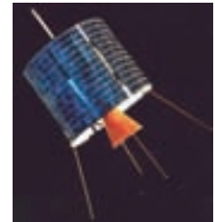
Fotografía del primer satélite de comunicaciones en órbita geoestacionaria Intelsat I ó Early Bird, lanzado por Estados Unidos el 6 de abril de 1965 que unió permanentemente Europa y América a través de 240 canales telefónicos o un canal televisivo.
