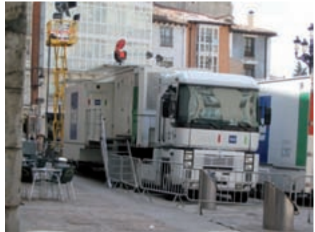
Unidad móvil que tiene desplegadas la petacas y escaleras (zonas de trabajo suplementarias), con un radioenlace en el techo. Al lado izquierdo está la plataforma para los camarógrafos, etc. Foto: Carlos Alberto Martín.
