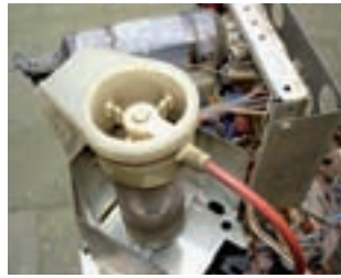
(Izda.) Tubo de imagen delta con las bobinas de un televisor de color de los primeros años.
