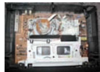
Fotografía del interior del grabador de vídeo VHS con la tapa de arriba quitada.
