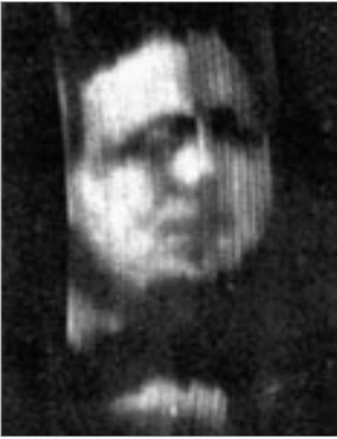
Figura 8. Fotografía tomada de la imagen reproducida con uno de los primeros televisores de Baird. En ella se pueden apreciar, con total nitidez, las líneas producidas por el mecanismo de barrido óptico de la imagen, las cuales dejan una traza vertical y algo curvada, debido a la forma del disco de Nipkow. Fuente: Dinsdale-1926, p. 38.
