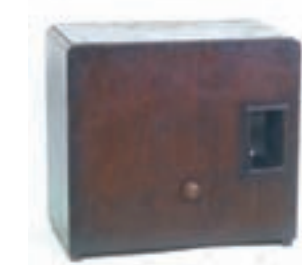
Figura 8. Modelo primitivo de televisión de las décadas de 1920 y 1930 de Baird. Obsérvese el pequeño tamaño de la pantalla y su posición vertical en comparación con la enorme carcasa. (Museo Nacional de Ciencia y Tecnología. Madrid).
