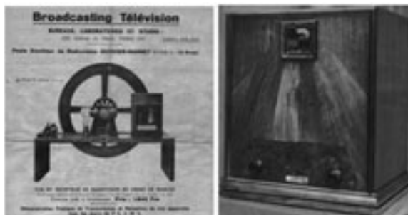
Fig. 28.- Izda.: Extracto de un anuncio publicitario de 1935. Se publicita un Kit de televisión basado en el disco de Nipkov suministrado por Duvier-Marret. Dcha.: Receptor de televisión completo de Onda Media a 60 líneas horizontales y relación de aspecto 1/1 fabricado por Roger Dupoy en 1935.
