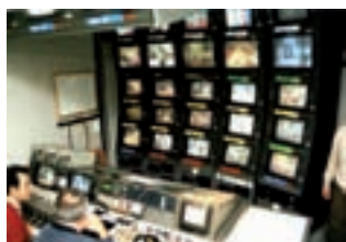
Control de cámaras y panel de monitorado de una unidad C, debajo del cual se ve las CCU de las 8 cámaras de la unidad. Foto: Javier Herraiz TVE
