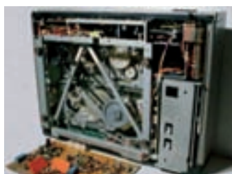
Fotografía del interior del grabador doméstico sistema Betamax de Sony por la parte de abajo sin la cubierta de apoyo.
