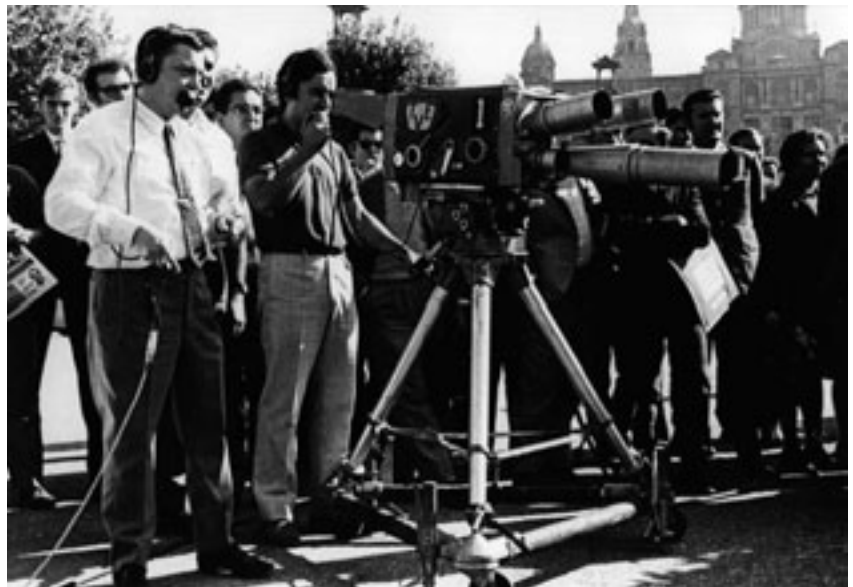
Cámara de televisión de los primeros años de TVE. Al fondo se puede ver el Palacio de Comunicaciones, sede de la Dirección General de Correos y Telecomunicación. La cámara presenta tres objetivos diferentes. En esa época se empieza a establecer la normativa necesaria para ayudar a promocionar este servicio: fabricación de receptores nacionales y la autorización a los inquilinos para colocar antenas en las viviendas. Fuente: TVE.
