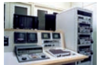
Sala de edición Betacam, los magnetoscopios están en el rack y en primer plano se ve el editor.
