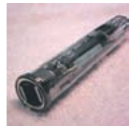
Fotografía del saticón tubo de imagen diseñado por Hitachi en 1973.
