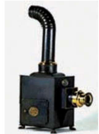
Linterna mágica. Este equipo realizaba el proceso inverso al de una cámara oscura: reflejaba las imágenes desde dentro hacia fuera. Se podría comparar con un proyector de diapositivas. Las imágenes se pintaban en un cristal que se colocaba en la ranura de la cámara. Las imágenes se proyectaban en una pared y se podían aumentar o disminuir en función de la destreza del operario.
