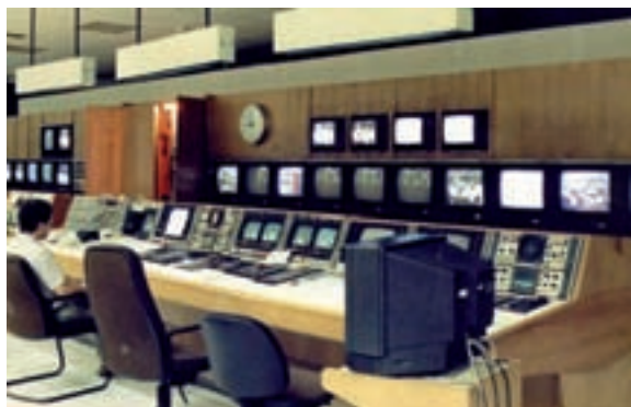
Sala de control central de TVE. En ella se pueden ver los diferentes monitores que muestran las distintas señales de televisión que se van enviando al aire. Los controles de audio situados en las mesas permiten subir y bajar sonidos para conseguir que el audio tenga una buena calidad.
