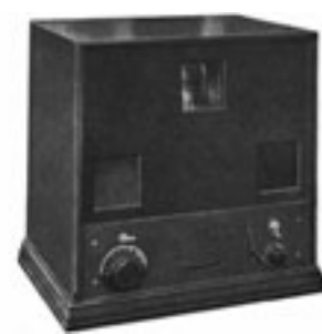
Fig. 1.-Vista interior (Arriba) y vista con carcasa (Abajo) del receptor de televisión mecánico fabricado en Alemania por Fernseh A. G. a comienzos de los años 30 para la banda de Onda Media. Con este aparato podían visionarse imágenes exploradas a 30 líneas verticales (caso de Baird en el Reino Unido) y a 30 líneas horizontales (caso de Barthélemy en Francia). Se distinguen dos pantallas, una para cada norma. La central superior es para líneas horizontales. La inferior derecha es para líneas verticales. En la parte inferior derecha se aprecia la palanca selectora.
