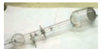
(Arriba) Boris Rosing. (Abajo) Tubo de Braun adaptado por Rosing para poder ser utilizado como pantalla de un receptor de televisión.
