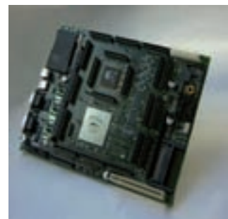
Sistema de emulación de SIDSA para desarrollo de sistemas de chips de silicio en aplicaciones multimedia.
