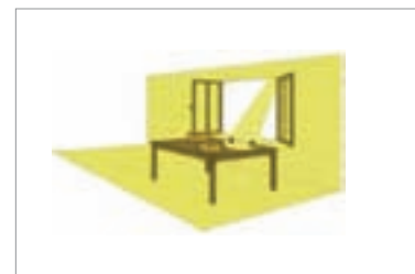
Descubrimiento de Joseph May. La resistencia eléctrica de una bobina de hilo de selenio, usada para ajustar la corriente telegráfica, variaba al incidir sobre ella la luz del sol.
