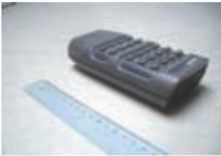
Mando a distancia de un televisor Philips de 1978 que ya poseía un teclado numérico para gobernar el teletexto y que usaba los infrarrojos para comunicar con el televisor.
