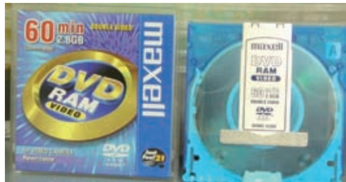
Fotografía de la caja y de un disco DVD-RAM de 8 cm (doble cara) usado en la cámara Hitachi.
