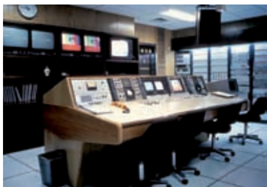
Control central de Prado del Rey, cuando ya existía Torrespaña. En la fotografía se aprecia en el lado de la derecha un equipo parecido a un ordenador (Tektronix Answer) que era un equipo de medida de señales de prueba automatizada. Fuente:TVE.
