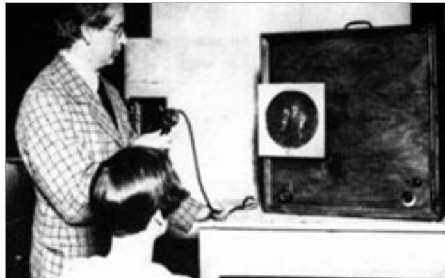
Figura 9. Fotografía donde aparece Baird con uno de sus primeros televisores comerciales. La imagen resultante puede verse en la pequeña pantalla redonda que se encuentra en el lado izquierdo de la caja. Baird, por su parte, sostiene en su mano un dispositivo para ajustar el sincronismo de la imagen. Fuente: Baird Laboratory Glass Lecture Slides, Baird-1930.
