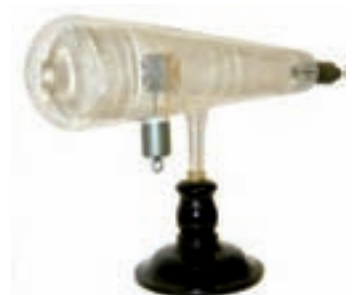
(Arriba) William Crookes. (Abajo) Tubo de vacío de su invención con una cruz de Malta en su interior que se abatía por efecto del paso de los rayos catódicos, los cuales parecían golpear el material con el que estaba hecha la cruz.
