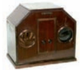
Televisor mecánico de Baird de 1928. Se estima que fueron construidos unos 30 receptores de este modelo. Obsérvese el pequeño tamaño de la pantalla.
