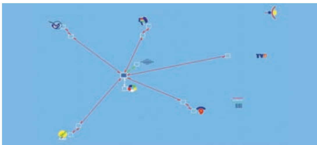
Red de Contribución FORTA. Esquema de la red facilitada por Retevisión a TVG, Telemadrid, Canal Sur; Canal 9, TV3 y ETB para su uso exclusivo y permanente en el intercambio de programas.
