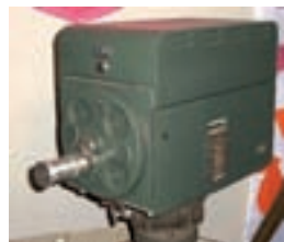
Cámara orticón-imagen similar a las primeras de TVE.
