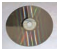
Fotografía del disco óptico de vídeo llamado Laserdisc que permitía 60 minutos de vídeo por cara en el tamaño de los discos de sonido de polivinilo (33 cm. de diámetro).
