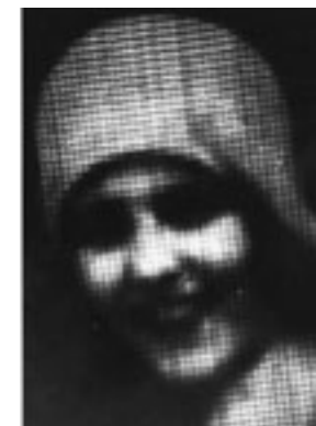
Las imágenes anteriores muestran una imagen de una pantalla de televisión en el que se aprecian las pequeñas y estrechas líneas que dividen la imagen. El gráfico muestra la onda obtenida de una línea de exploración. Fuente: Television Today , 1931.
