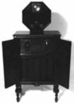
Fig. 7.- Receptor de televisión fabricado en 1928 por la General Electric Company. Se utilizó para recibir las imágenes transmitidas en la banda de 2 MHz en los Estados Unidos.
