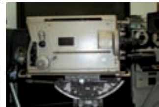
Cámaras de televisión de Marconi (MK-IV) en las que se incorporaba con un orticón-imagen. A pesar de su gran tamaño fueron muy utilizadas. En las fotografías se pueden ver los distintos objetivos de zoom que permiten fácilmente cambiar la distancia focal.
