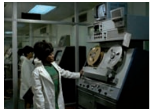
Magnetoscopio utilizado por Televisión Española para grabar los programas de televisión. Con el desarrollo de los equipos de montaje, la función de «radiodifusión diferida» dio paso a las funciones de «producción».
