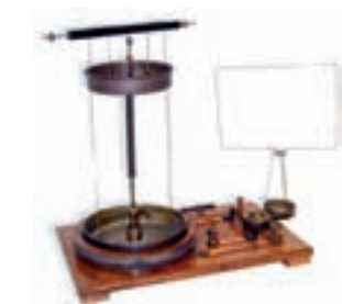
La mesa de Ampère, 1890. Reproducción del aparato, que construyó Ampère, para realizar su experimento, en el que medía la relación existente entre los campos magnéticos y las corrientes eléctricas.
