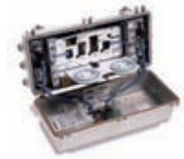
Equipo de conversión electro-óptica, de un nodo final de la red. En el se pueden apreciar, los accesos de las fibras ópticas
