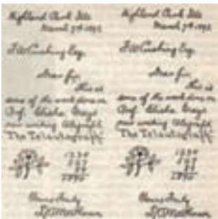
Ejemplo de un mensaje recibido y su original, transmitido con el telautograph.
