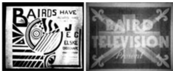
Fig. 14.- Ejemplo de imágenes transmitidas en la banda de VHF por Baird desde el Crystal Palace de Londres, en las que el formato de presentación había cambiado de 3/7 a 4/3.
