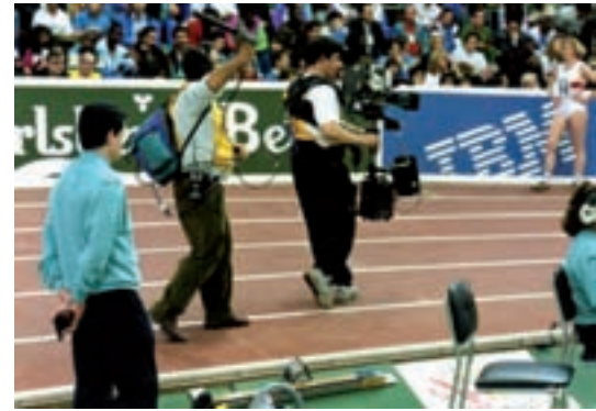
Camarógrafo con el arnés y contrapesos de un sistema stedycam y enlace de envío de la señal. Fuente TVE.
