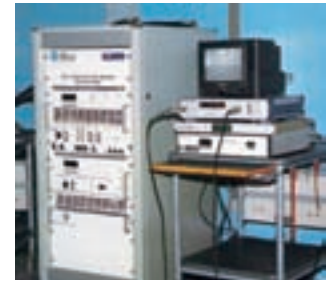
Gap Fillers para DVB-T Mier diseñó el primer Gap Filler español para emisiones de televisión digital.
