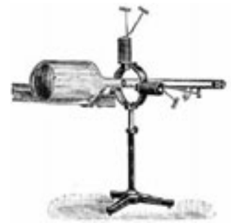
Sistema empleado por Braun para colocar las bobinas de los electroimanes. De esta forma, el haz de rayos catódicos podía ser desviado horizontal y verticalmente, y barrer la pantalla completa al ritmo que marcaba la corriente que circulaba por los electroimanes.
