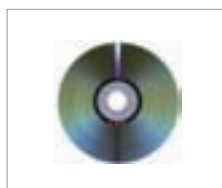
Digital Versatile Disc (DVD) de 12 cm de una capa que permitía almacenar una película de dos horas con 8 lenguajes de audio distintos y 32 subtítulos.
