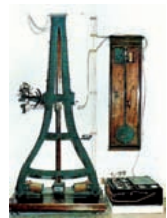
Fotografía de un pantelégrafo, donde se ven: el péndulo motor del mecanismo de inscripción, el péndulo de sincronización de línea y las pilas.
