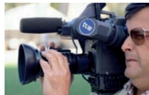
Camcorder utilizado principalmente para el periodismo electrónico. Algunas de estas cámaras llevan incorporado un pequeño grabador/reproductor adecuado para señales de televisión o un magnetoscopio. En la fotografía se puede ver una cámara con micrófono. Fuente :TVE.
