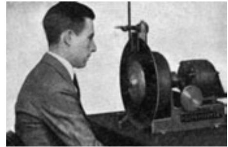
Figura 6. Mecanismo interno de un receptor de televisión mecánica sin la carcasa. Se observa el disco de Nipkow y la pequeña pantalla a la altura de los ojos del espectador: (El cine sonoro y la radiovisión. 1935. pp 35).
