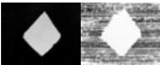
(Izda.) Imagen que se enfoca en el transmisor de Bidwell (Dcha.) Imagen que se recibe en el receptor de Bidwell.
