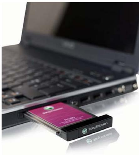
→ Fig. 3. Acceso a Internet mediante un portátil con una PCMCIA móvil
