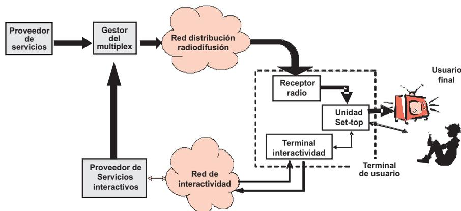
Figura 5.1. Esquema simplificado de la TV interactiva
